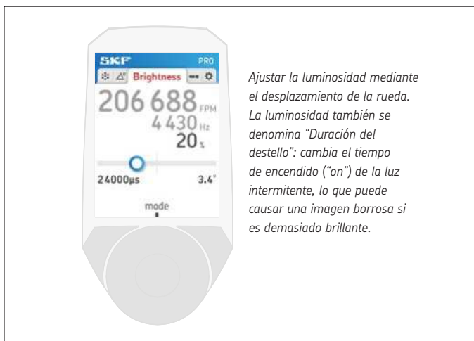
Fig. 17: Luminosidad/duración del destello
